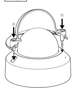
③ 本機をエンクロージャーに仮固定し、本機に装 着されている長いエンクロージャー固定ねじ を時計回りに回転させ、カメラのエンクロー ジャーを貫通させる。
